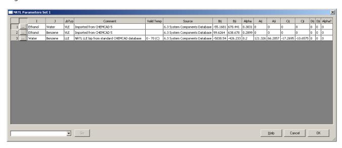
Wasser-Benzol stammen aus dem LLE Buch der Dechema Data collection und stehen erstmalig in CC6 zur Verfügung. Alle anderen Daten sind identisch mit denen in CC5.
