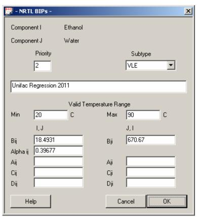
Hier sind die oben erhaltenen Daten aus der UNIFAC Regression in das zunächst leere Menü eingetragen. Eine automatische Übernahme ist z.Z. nicht möglich. Wählt man "Simulation", erfolgt die Speicherung in den Job, ansonsten in eine Datenbank.
