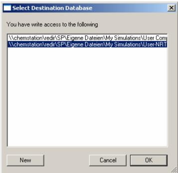
Die Regressionsdaten stehen nun sowohl unter "Simulation" als auch unter "User-NRTL" zur Verfügung. Würde man nun erneut "Edit BIPs" wählen und mit Ethanol und Wasser auf die 3 Punkte in der 1. Zeile klicken, könnte man dies sehr gut nachvollziehen.
