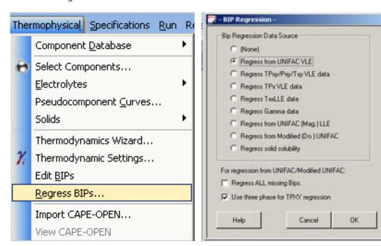
Es stehen mehrere Möglichkeiten zur Verfügung, je nachdem welche Datenquelle vorliegt. Alle Unifac Methoden nutzen die Generierung von Phasengleichgewichten mit Unifac und berechnen daraus die 3 NRTL-Parameter. Alle anderen Methoden benötigen Messdaten.
