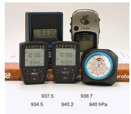
Der Vergleich mehrerer Barometer macht die begrenzte absolute Genauigkeit handelsüblicher Geräte deutlich.
